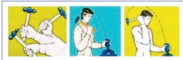
Նկ. 44 Հարվածի տեսակները հատման ժամանակ. ա – դաստակային, բ – արմունկային, գ – ուսային
