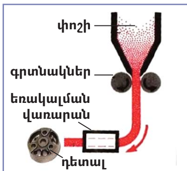
Նկ. 25 Դետալի պատրաստումը փոշեմետալուրգիական եղանակով
