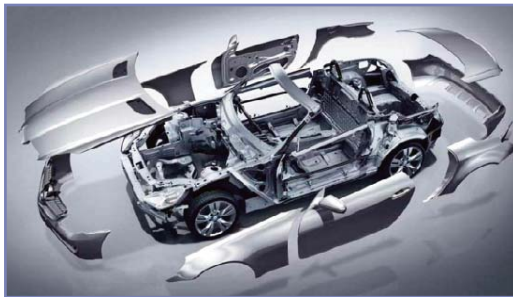
Նկ. 17 Կոնստրուկցիոն պողպատից պատրաստվում է ավտոմեքենայի թափքը
