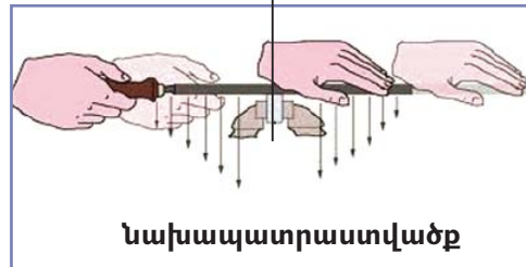
Նկ. 58 Ձեռքերի սեղման ուժի փոփոխությունը ըստ խարտոցի տեղաշարժման
