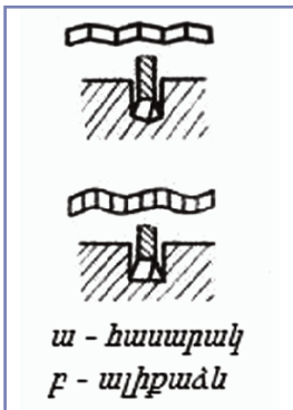
Նկ. 47 Սղոցաժապավենի ատամների չափրաստման տեսակները
