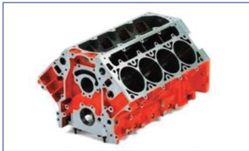
Նկ. 19 Թուջից պատրաստում են ավտոմեքենայի շարժիչի և հաստոցի հիմնական մասերը
