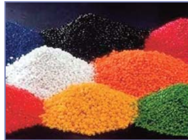
Նկ. 27 Պլաստմասսայի հումք, գունավորված պիգմենտներով
